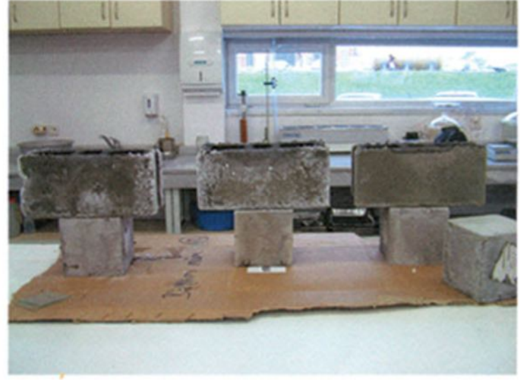
Resim 4: Su ile tam doldurulmuş, AQUAFIX KRİSTALİZE SU YALITIM HARCİ uygulanmış tüm biriket numunelerin 60. gündeki görünümü
