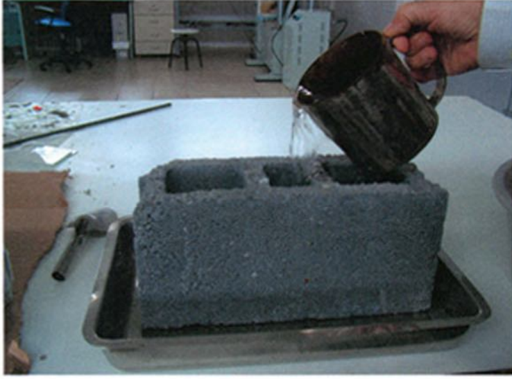
Resim 1: Şahit numunede su dolumu ile aynı anda suyun sızmaya başlaması
