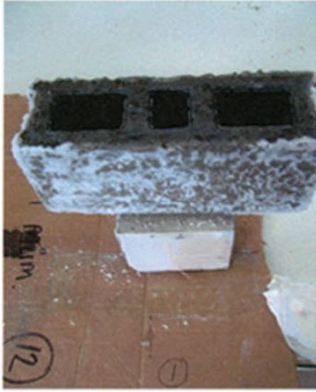
Resim 3: Su ile tam doldurulmuş, AQUAFIX KRİSTALİZE SU YALITIM HARCİ uygulanmış biriket numunenin 60. gündeki görünümü
