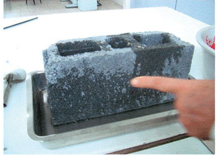
Resim 2: Şahit numunenin doldurulduğu andan itibaren alt ve yan yüzlerinden su sızma görüntüsü
